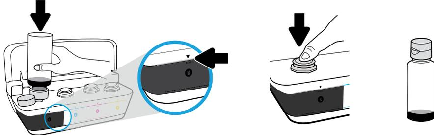
Вставьте бутылку в отверстие емкости. Заполните емкость чернилами до линии. Плотнo закройте емкость, надавив на пробку.
