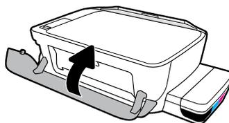
Закройте крышку доступа к печатающим головкам и переднюю дверцу принтера.
