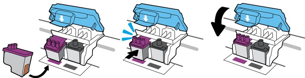
Установите печатающие головки до щелчка. Плотно закройте синий фиксатор.
