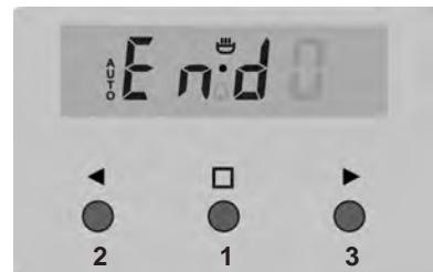
Abschaltzeitpunkt (Betriebsende) mit den Tasten **3** und **2** einstellen; der kann nur um maximal 23 Stunden und 59 Minuten vom aktuellen Zeitpunkt entfernt sein,
