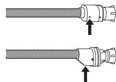
Для шлангов с устройством защиты от протечки: проверьте состояние смотрового окошка предохранительного клапана (см. стрелку). Если оно покраснело, это означает, что сработала функция защиты от протечки, и шланг следует заменить на новый. Чтобы открутить этот шланг, нажмите кнопку фиксатора (при ее наличии) и открутите шланг.
