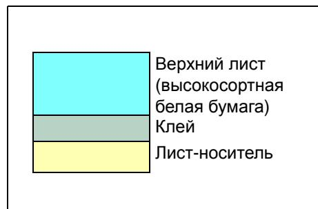
Этикеточная бумага имеет трехслойную структуру, как показано на схеме. Верхний лист печатается. Клейкий слой состоит из чувствительного к давлению клейкого вещества. Лист-носитель (его также называют линейным или подкладочным листом) удерживает этикетки до использования. Из-за сложности своего состава этикеточная бумага с клееной подкладкой наиболее подвержена проблемам при печати.
