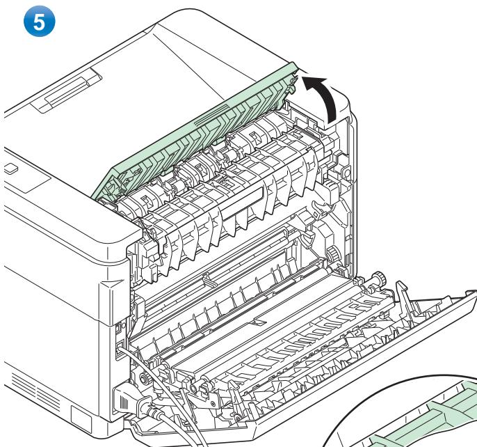
**ВНИМАНИЕ** Блок термофиксатора, установленный внутри принтера, очень горячий. Во избежание ожогов не дотрагивайтесь до него.
