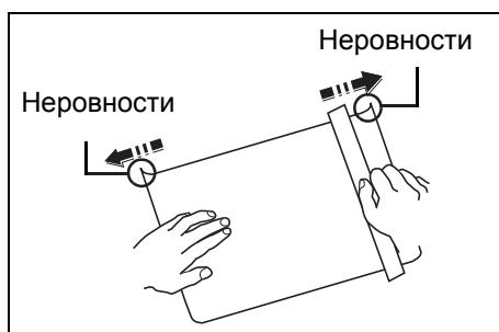
Перед загрузкой стопки бумаги во входной лоток пролистайте бумагу веером и выровняйте края. Бумага некоторых типов имеет неровные края на тыльной стороне (образовавшиеся в результате нарезки бумаги). В этом случае положите бумагу на ровное место и для разглаживания протрите ее края один или два раза, например, линейкой. Подача бумаги с неровными краями может вызвать застревание.
