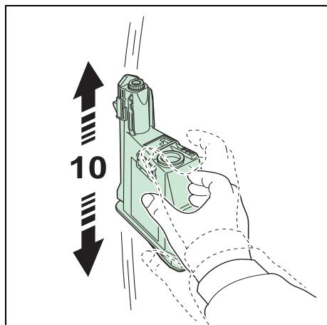
**3** Достаньте новый картридж с тонером из комплекта тонера. Встряхните новый картридж с тонером не менее 10 раз, как показано на рисунке, для равномерного распределения тонера.
