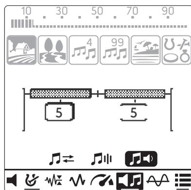
Вы можете изменить громкость звукового сигнала с помощью кнопок "плюс" (+) и "минус" (-). Чтобы выбрать следующую зону, нажмите кнопку "Баланс грунта / Подтверждение".
