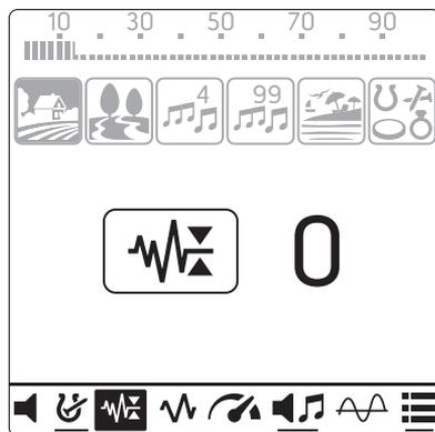
Настройка стабилизации грунта не может быть использована в режиме "Все металлы" и, следовательно, не может быть выбрана.
