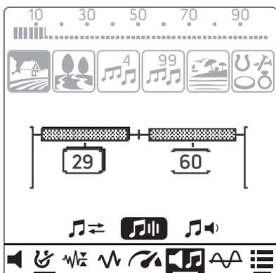
Вы можете изменить частоту звукового сигнала с помощью кнопок "плюс" (+) и "минус" (-). Чтобы выбрать следующую зону, нажмите кнопку "Баланс грунта / Подтверждение".
