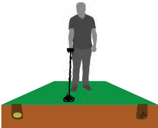
2. Нажмите и удерживайте нажатой кнопку "Баланс грунта / Подтверждение" и начните перемещать поисковую катушку вверх и вниз примерно с 15–20 см (~ 6" - 8") над землей до 3 см (~ 1") от земли плавными движениями, удерживая ее параллельно земле.
