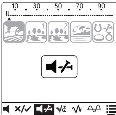
■ В версии ULTRA: После нажатия кнопки "Питание и Настройки" используйте правую и левую кнопки для выбора настройки дискриминации. Нажмите кнопку "Баланс грунта / Подтверждение", чтобы получить доступ к расширенным настройкам. Используя правую и левую кнопки, выберите параметр "Выключение железа" который является вторым в списке. Вы можете включить железо с помощью кнопок "плюс" (+) и "минус" (-).
