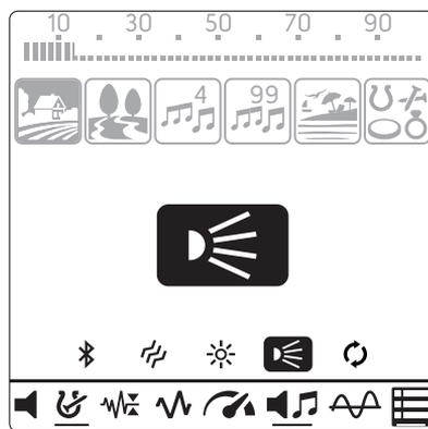
Светодиодный фонарик всегда возвращается в выключенное положение при выключении и повторном включении устройства. Эта настройка является общей для всех режимов; изменения, внесенные в любом режиме, также применяются к другим режимам.
