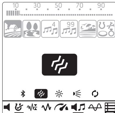
Вибрация может не ощущаться в режиме "Все металлы" при слабых сигналах; она начнет ощущаться по мере усиления сигнала. Другими словами, вибрация начинается не на той глубине, где слышны звуковые сигналы, а на меньшей глубине. Следовательно, если вы работаете только с вибрацией и звуковые сигналы отключены, вы можете пропустить более слабые и глубокие сигналы.
