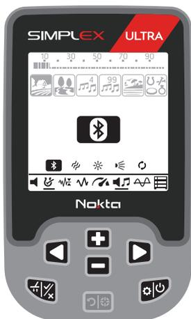
2. Вы можете включить или выключить соединение Bluetooth® с помощью кнопок плюс (+) и "минус" (-). Когда он выключен, поле будет отображаться белым цветом, когда оно включено, оно будет черным.
