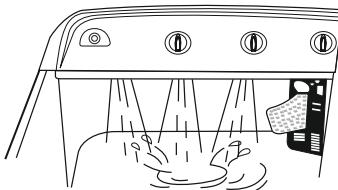
\* Отметки уровня воды расположены на корпусе фильтра для сбора ворса и пуха. Значения уровня налива воды: L-минимальный уровень, H-максимальный. Данные метки рассчитаны для загрузки машины вместе с бельем. Учитывайте это при наливе воды. Оставляйте место для белья. Если на Вашей модели нет на корпусе видимых меток уровня воды, то за максимальный уровень следует принимать уровень воды на 3-5 см ниже переливного отверстия.
