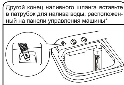
\* на модели WS-35E нет патрубка, налив воды осуществляется напрямую в бак стирки. На некоторых модификациях модели WS-85PE патрубок располагается не на панели управления, а рядом с крышкой бака стирки.
