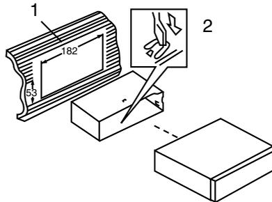
1. Установите монтажный кожух в приборную панель автомобиля, убедитесь, что он установлен правильной стороной и нет препятствий (провода, элементы приборной панели) для установки магнитолы.
