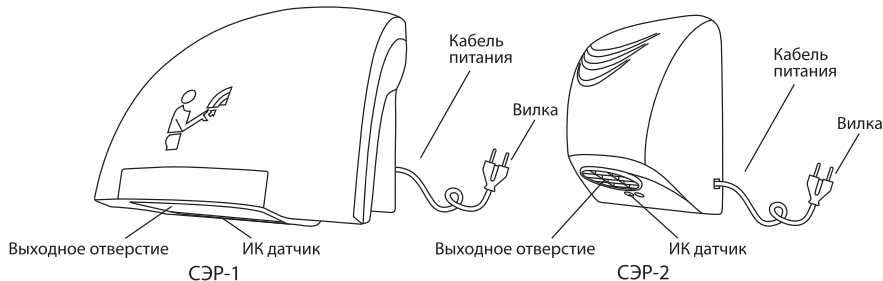
Рисунок 1. Устройство сушилок для рук
