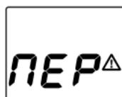
З.У. имеет электронную защиту от переполюсовки. При неправильном подключении З.У. отключается от аккумулятора, на экране замигают надпись “PER” и значок тревоги. После отсоединения клемм З.У. от аккумулятора работоспособность З.У. автоматически восстанавливается.
