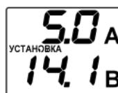
При изменении положения переключателя напряжения и/или ручки установки тока на экране отобразится надпись “УСТАНОВКА”, устанавливаемое значение будет мигать в течении нескольких секунд.
