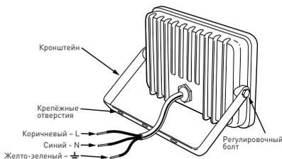
После подключения всех жил провода и проверки корректности подключения, необходимо обеспечить герметичность соединения (например, с помощью герметика).
