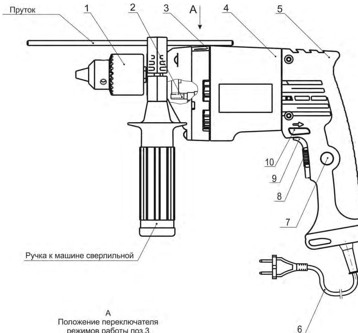
1 - патрон; 2 - редуктор; 3 - переключатель режимов работы; 4 - электродвигатель; 5 - ручка-накладка; 6 - шнур питания; 7 - кнопка-фиксатор; 8 - маховичок; 9 - клавиша выключателя; 10 - переключатель реверса.
