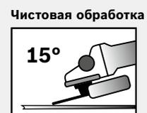
Оптимальная чистовая обработка. Мелкая зернистость обеспечивает отличный результат по сравнению со стандартными обдирочными кругами
