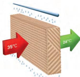
*Система управления управляет водяным насосом и вентилятором, который нагнетает холодный воздух в помещение.*
