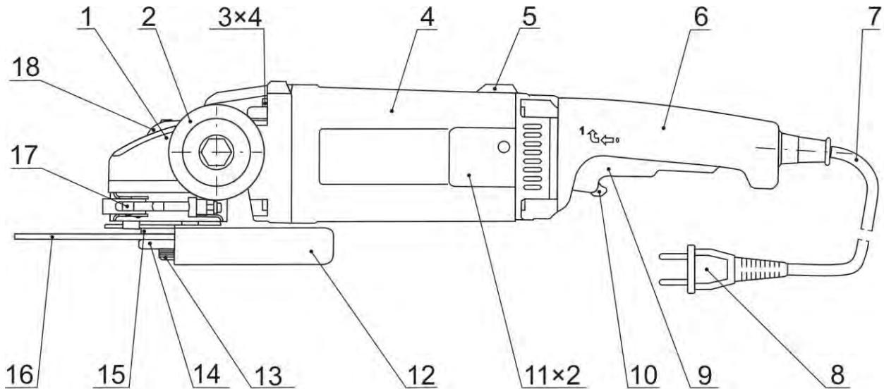
1 - редуктор; 2 - ручка; 3 - винт; 4 - электропривод; 5 - упор; 6 - ручка с выключателем;
