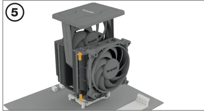
Установите 135-мм вентилятор Silent Wings по центру между двумя половинами радиатора и плотно прижмите. Подключите оба вентилятора с помощью Y-кабеля. Вы можете отрегулировать положение Silent Wings 4 120mm, переставив скобы крепления на радиаторе.
