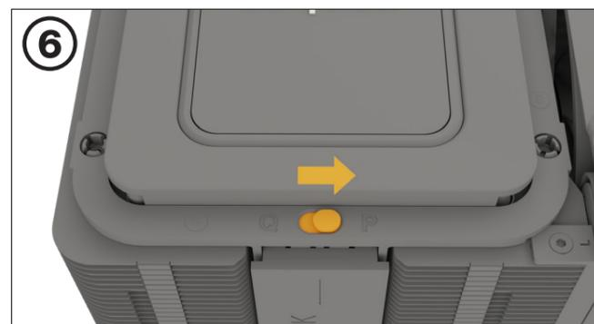
Dark Rock Elite имеет тихий (Q) и производительный (P) режимы. Выбранный режим устанавливает максимальную скорость вращения вентилятора и рабочий шум. Чтобы изменить режим, снимите верхнюю крышку на магнитах и передвиньте переключатель.
