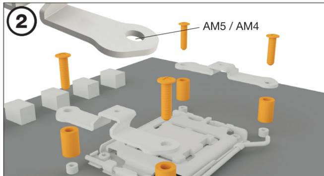
Наживите 4 распорные гайки AMD на выступающие через переднюю часть материнской платы болты задней панели и закрепите длинные кронштейны AMD винтами задней пластины AMD.
