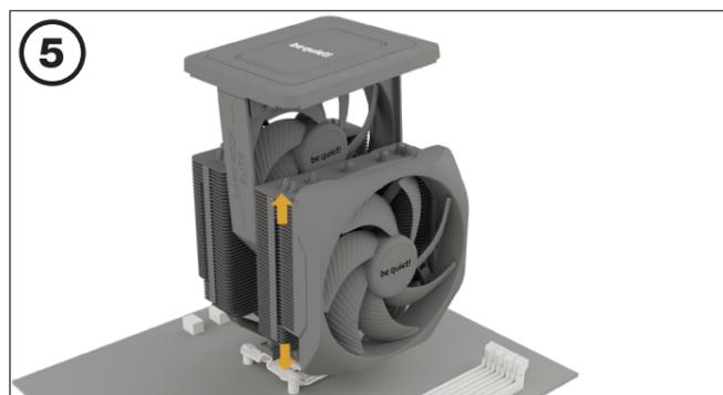
Установите 135-мм вентилятор Silent Wings по центру между двумя половинами радиатора и плотно прижмите. Подключите оба вентилятора с помощью Y-кабеля. Вы можете отрегулировать положение фронтального вентилятора Silent Wings 135mm, перемещая его вверх или вниз.
