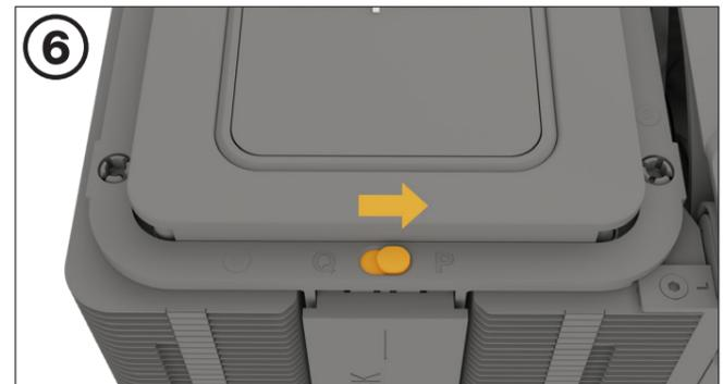
Dark Rock Elite имеет тихий (Q) и производительный (P) режимы. Выбранный режим устанавливает максимальную скорость вращения вентилятора и рабочий шум. Чтобы изменить режим, снимите верхнюю крышку на магнитах и передвиньте переключатель.
