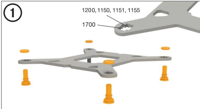
**Монтаж задней пластины**
