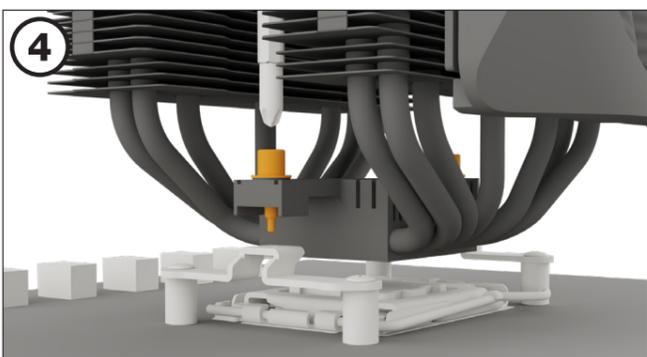
Установите кулер на процессор. Затяните попеременно винты крепежного моста. Используйте для этого соответствующую крестообразную отвертку.
