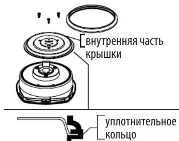
Выкрутите винты из внутренней части крышки и снимите ее. Затем снимите уплотнительное кольцо и установите вместо него новое. После этого закрепите внутреннюю часть крышки обратно с помощью винтов.
