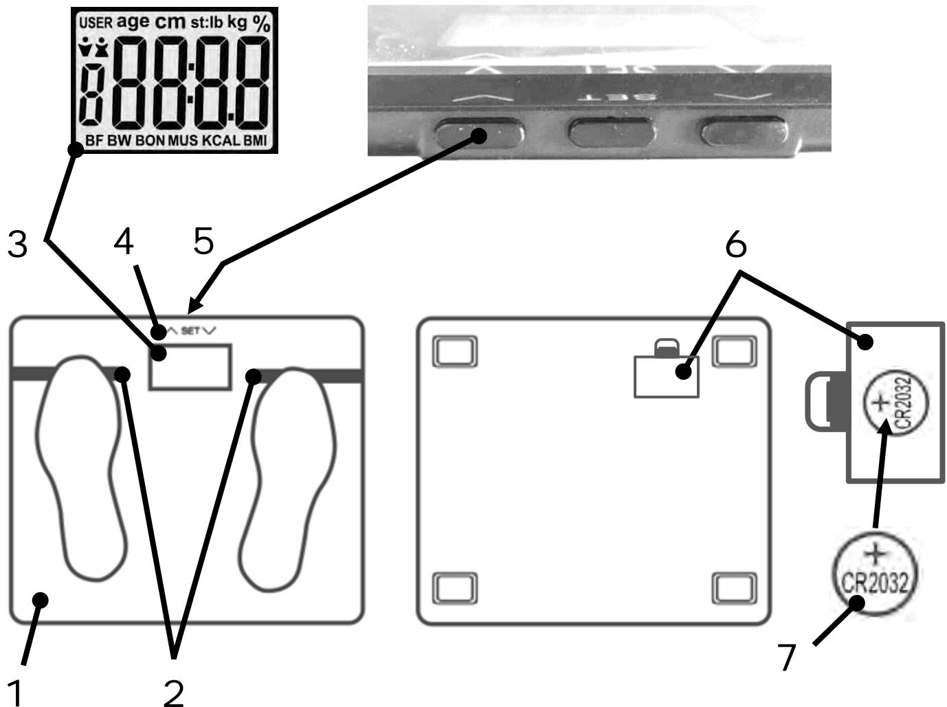
**1. Корпус****2. Электроды****3. ЖКИ - экран****4. Пиктограммы кнопок: ▲ (ВВЕРХ) / SET / ▼ (ВНИЗ)****5. Кнопки: ВНИЗ / SET / ВВЕРХ (находятся в торце устройства)****6. Отсек для батареек****7. Батарея 3V CR2032 (1 шт. в компл.)**
