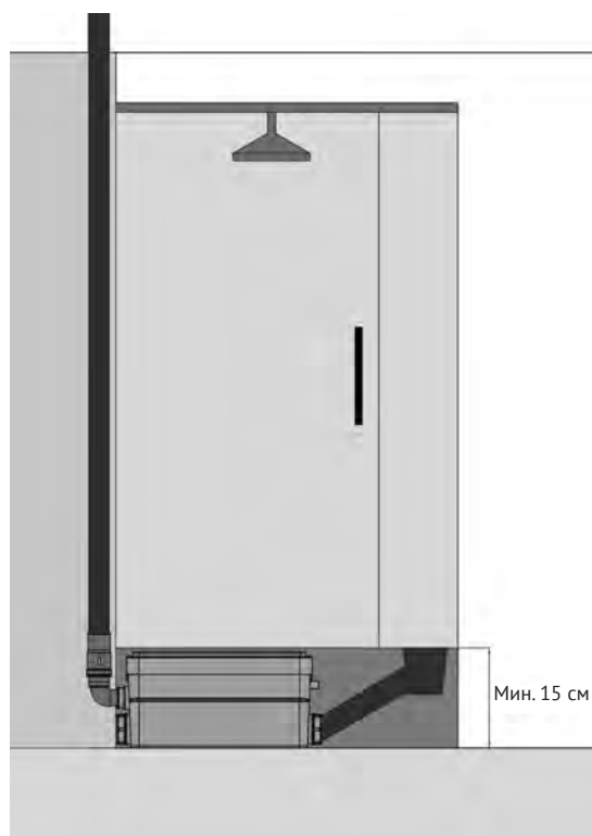
Рисунок 5 – Установка КНС под душевым поддоном
