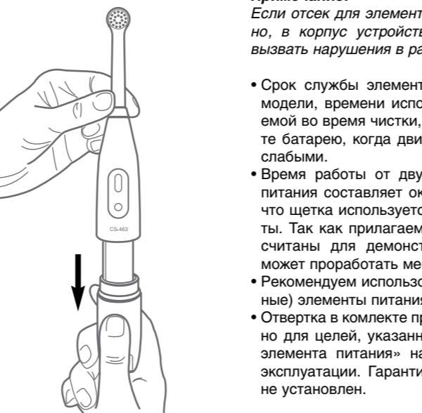
2. При помощи отвертки открутите винт и снимите защитную панель.
