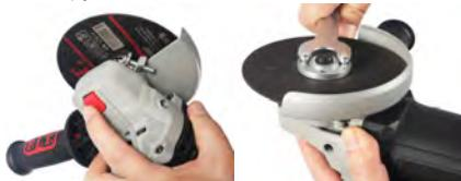
Для снятия и установки шлифовальной оснастки нажмите кнопку фиксации шпинделя, чтобы зафиксировать шлифовальный шпиндель.
