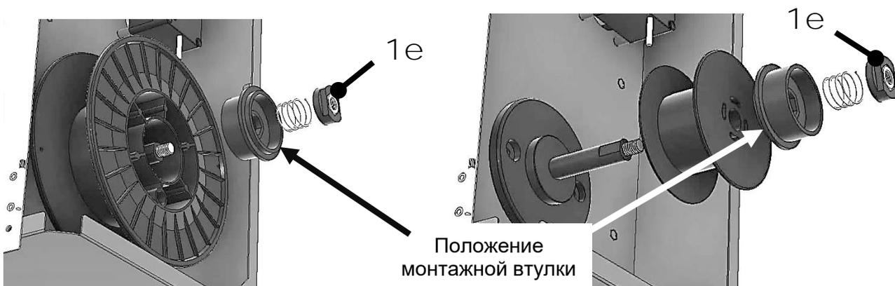
1e Гайка-регулятор прижима
