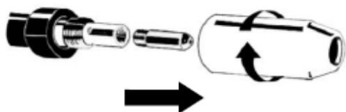
Снимите сопло и контактную трубку с головки сварочной горелки.
