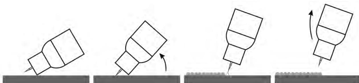
Коснитесь керамическим соплом горелки на свариваемую деталь, располагая горелку под углом и выдерживая при этом расстояние между электродом и деталью примерно 2-3 мм.
