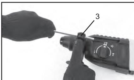
6.3.3 Установите требуемую глубину сверления и отпустите фиксатор глубиномера.
