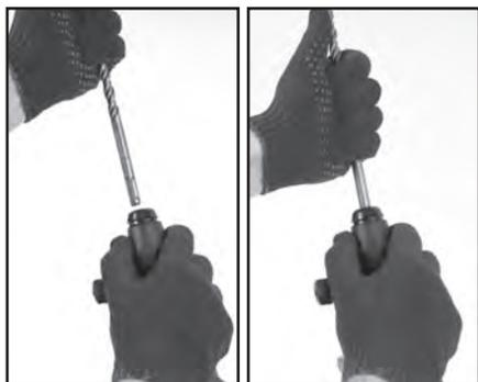
6.1.3 Убедитесь, что рабочий инструмент установлен правильно и зафиксирован внутри.
