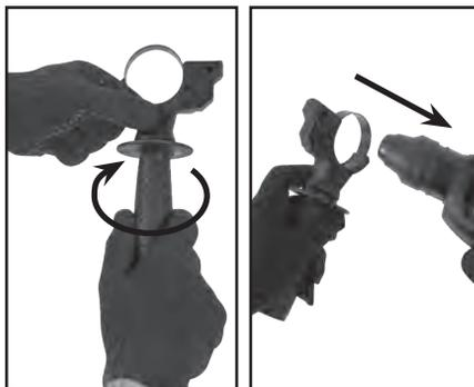
6.2.3 Зафиксируйте рукоятку путем вращения ее по часовой стрелке, предварительно установив ее в удобное для работы положение.
