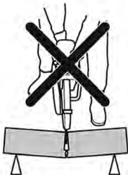
Рис. 14 Отдача при защемлении диска
