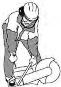
Рис. 7 Положение оператора при запуске двигателя
