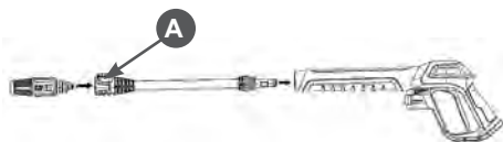
Рис. 3 Установка головки и струйной трубки
