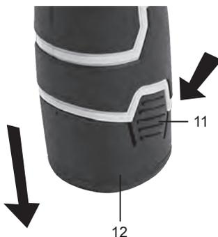
6.2.4 Отсоедините аккумулятор (12) от электроинструмента путем нажатия на фиксатор (11) и подключите к нему зарядное устройство.
