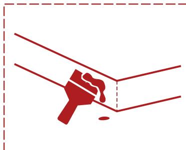
НАНОСИМ КЛЕЙ НА БОКОВОЙ КРАЙ УСТАНОВЛЕННОГО ПРОФИЛЯ,
