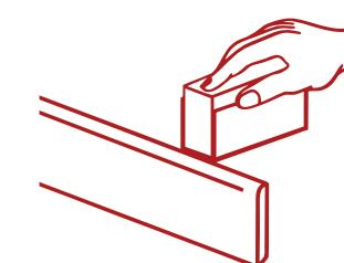
ПРОВЕРЯЕМ ТОЧНОСТЬ ПОДГОНКИ, ПРОТИРАЕМ ВЕТОШЬЮ
