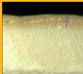
Сайдинг Döcke под микроскопом 200x
