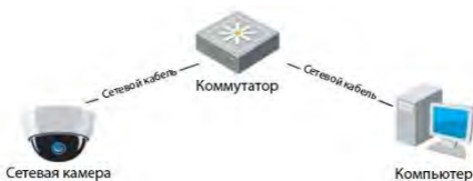
Рисунок 3-2 Соединение через коммутатор или роутер
