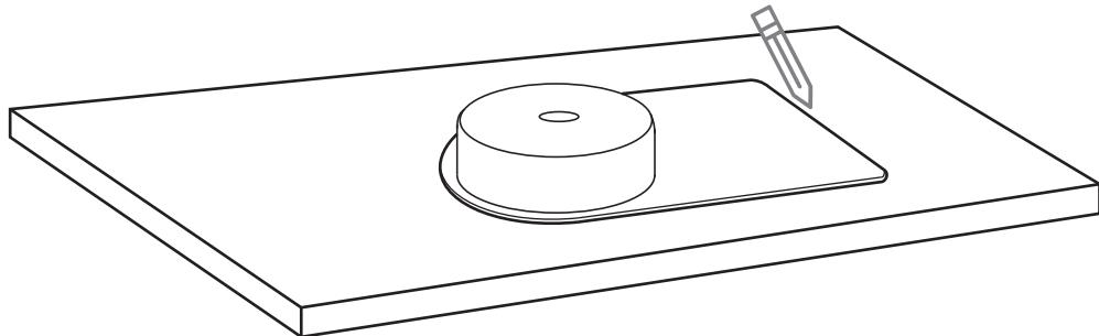
Измерьте ширину бортика мойки и, отступив на полученную величину, начертите внутренний контур линии отреза. Ширина бортика индивидуальна у каждой модели мойки.
