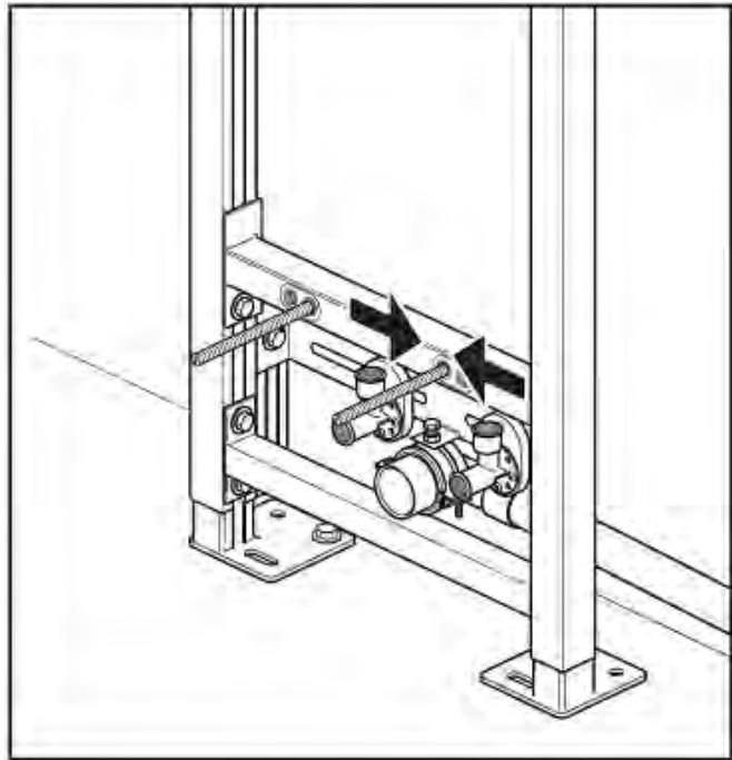
**10.** Ослабьте впускные колена для горячей и холодной воды (используя гайку сзади).
