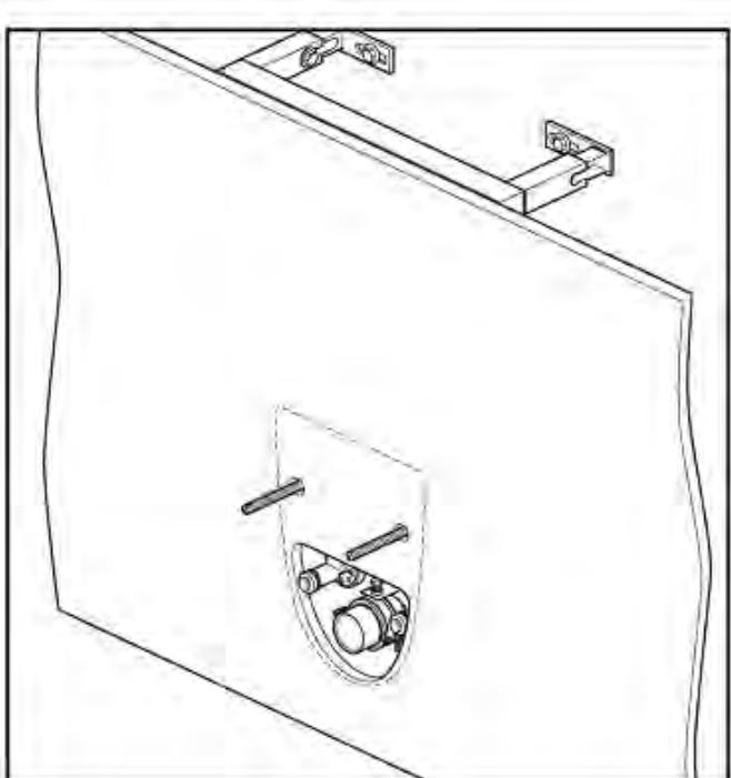
**12.** Постройте перегородку, проделав отверстия для болтов и труб. При необходимости выложите плитку на поверхность перегородки или нанесите отделку.
