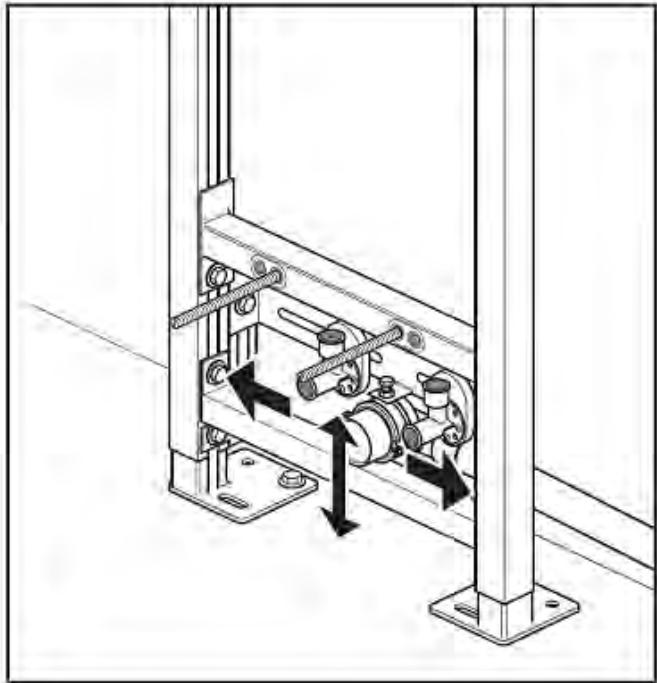
**9.** Ослабьте болты регулировки высоты опоры поперечины.
