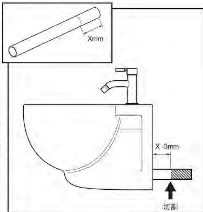
**13.** Вставьте «запасную» секцию сливной трубы полностью в слив
