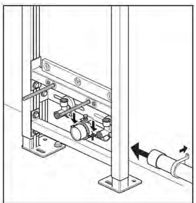
**7.** Осторожно поднимите и навесьте биде на крепежные болты. Ослабьте опорные болты крепления биде и установить планку на требуемую высоту. Ослабьте болты регулировки высоты соединения, установите опорную планку соединения на требуемую высоту на уровне выпускного колена для слива отходов. Снова затяните болты.
