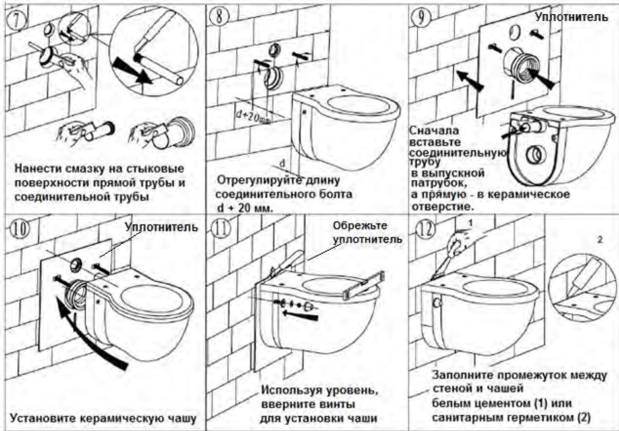
10Б. Стандартная установка унитаза скрытого монтажа (рис.11 -1 – 11-5).
