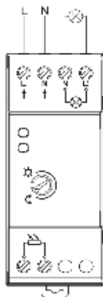
Рис. 3 Схема подключения фотореле DIN-1 (ФР)
