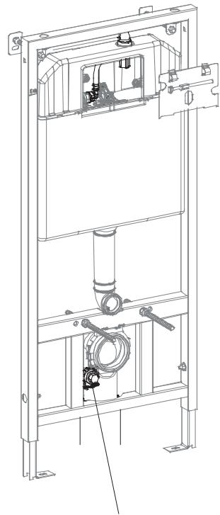
5. Аккуратно удалите крышку клапанного узла. Соедините гибкую подводку воды с угловым клапаном, надежно соедините узел. Проверьте все соединения углового клапана, чтобы предотвратить утечку и верните крышку клапанного узла на место.
