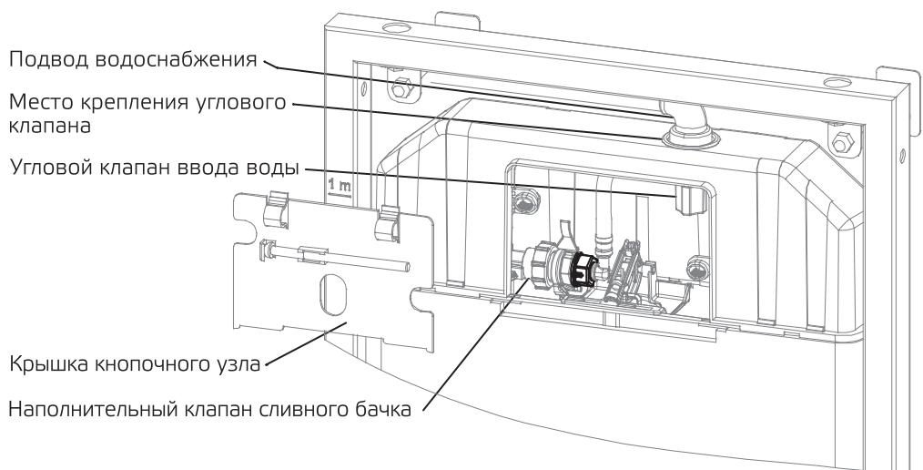
6. После выполнения всех этапов установки инсталляция теперь закреплена к стене и соединена с основной системой водоснабжения и канализации. Чтобы предотвратить проблемы загрязнения во время процесса цементирования или укладки плитки установите на время монтажа: заглушку впускной трубы, заглушку смывной трубы, защиту шпилек и защитный кожух клапанного узла.
