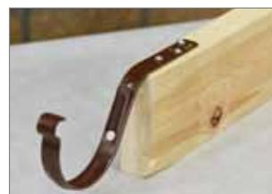
**1.4.** Прямой удлинитель или усиленный кронштейн применяются, если кровельное покрытие еще не смонтировано. Их крепят к стропильной ноге или обрешетке под кровельное покрытие.
