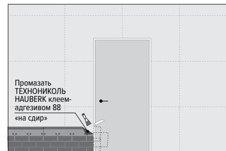
Рис. 7.1. Монтаж фасадной плитки вокруг дверных проемов
