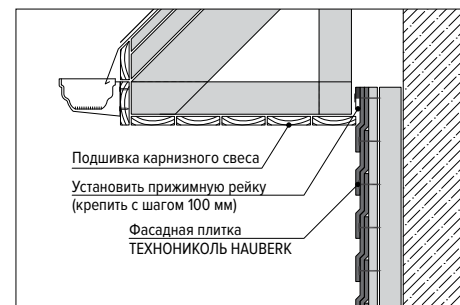
Рис. 9.1. Монтаж верхнего ряда под карнизным свесом
