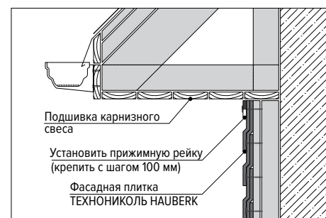
Рис. 9.2. Монтаж верхнего ряда под карнизным свесом
