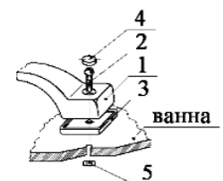
Схема №3. Крепление ручек.
