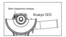
4. Чтобы снять кожух, выполните процедуру установки в обратном порядке.
