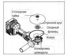
4. После начала резки и образования надреза на обрабатываемой детали не меняйте угол резки. Изменение угла приведёт к заклиниванию диска и может привести к его разрушению. Конструкция дисков для шлифования краёв не рассчитана на боковые нагрузки, возникающие при зажимании. 5. Прежде чем выключить инструмент поднимите его с обрабатываемой поверхности. Прежде чем положить инструмент, дождитесь полной остановки двигателя.
