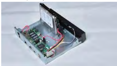
Подключите провода от ЖД к основной плате
