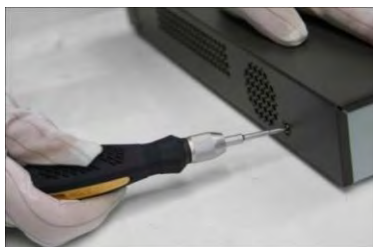
Ослабьте два верхних винта, чтобы снять крышку
