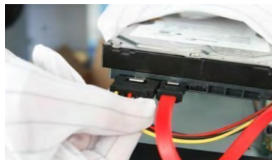
Подключите провод данных и провод питания к жесткому диску
