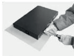
8) Зафиксируйте крышку винтами
