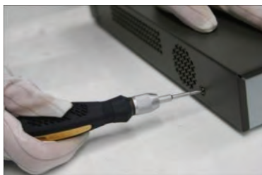
Ослабьте два верхних винта, чтобы снять крышку
