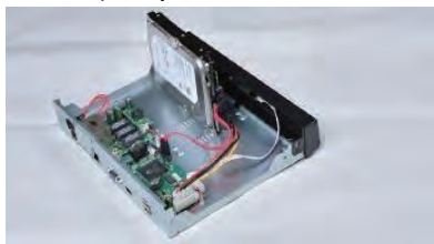
Ослабьте два верхних винта, чтобы снять крышку
