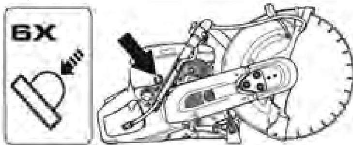
Рис. 9. Подкачка топлива праймером
