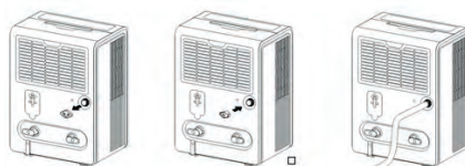
Перехідник — Ущільнювач Дренажний шланг
