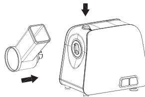
2. Вставьте барабан в насадку-овощерезку и слегка поверните для фиксации, как показано на рисунке.
