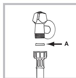
1. Підключити живлячий трубопровід, прикрутивши його до крану холодної води за допомогою штуцера з газовою різьбою 3/4 (див. малюнок).
