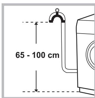
Підключіть зливний шланг, не згиночи його, до каналізаційного каналу або до входу до такого каналу на стіні, на відстані від 65 до 100 см від підлоги;
