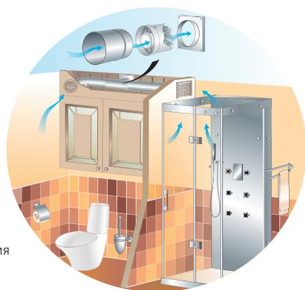
Вариант применения вентилятора ВКО в квартире
