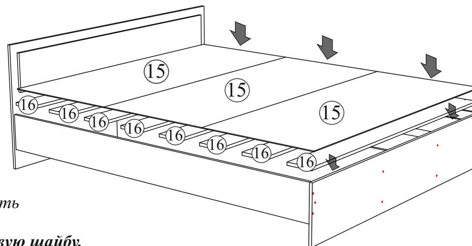
2. По окончании сборки кровати необходимо разложить настилы (детали № 16) и прикрутить их к планкам (детали № 4 и 8) с помощью шурупов 3,5x32 мм. Настилы расположить равномерно по всему свободному пространству внутри кровати.
