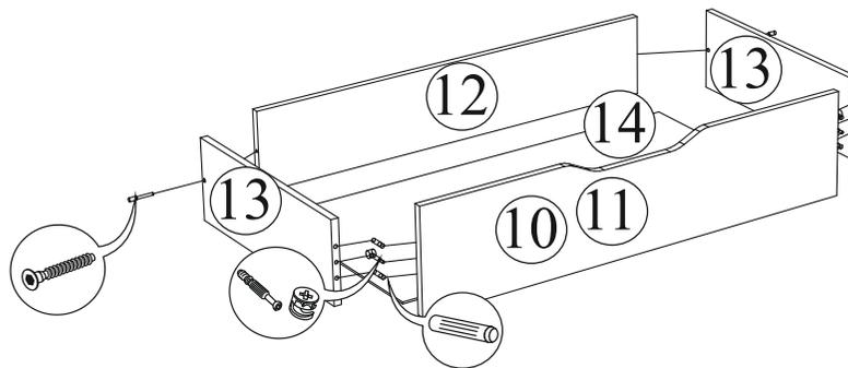
Для правильного открывания ящиков, необходимо выровнять диагонали каркаса ящика (Рис.1) и только потом прибить ЛДВП не нарушая диагонали.
