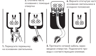
Рис.2. Схема подключения светильника SPO-6-36 (без клемника для БАП) к сети 220В.
