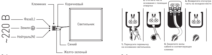
Рис. 1. Схема подключения светильника SPO-6-48 к сети 220В.
