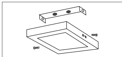
5.6. Зафиксируйте светильник на монтажной пластине (для квадратных светильников).
