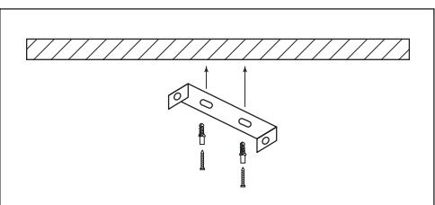
5.3. Установите монтажную пластину на опорную поверхность с помощью дюбелей и шурупов (входят в комплект поставки).
