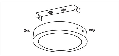
5.5. Зафиксируйте светильник на монтажной пластине (для круглых светильников).
