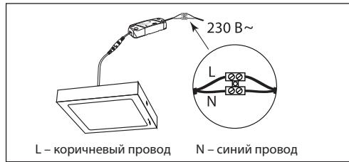
5.4. Подключите светильник с драйвером к электрической сети ~230 В с помощью клеммной колодки (в комплект не входит).
